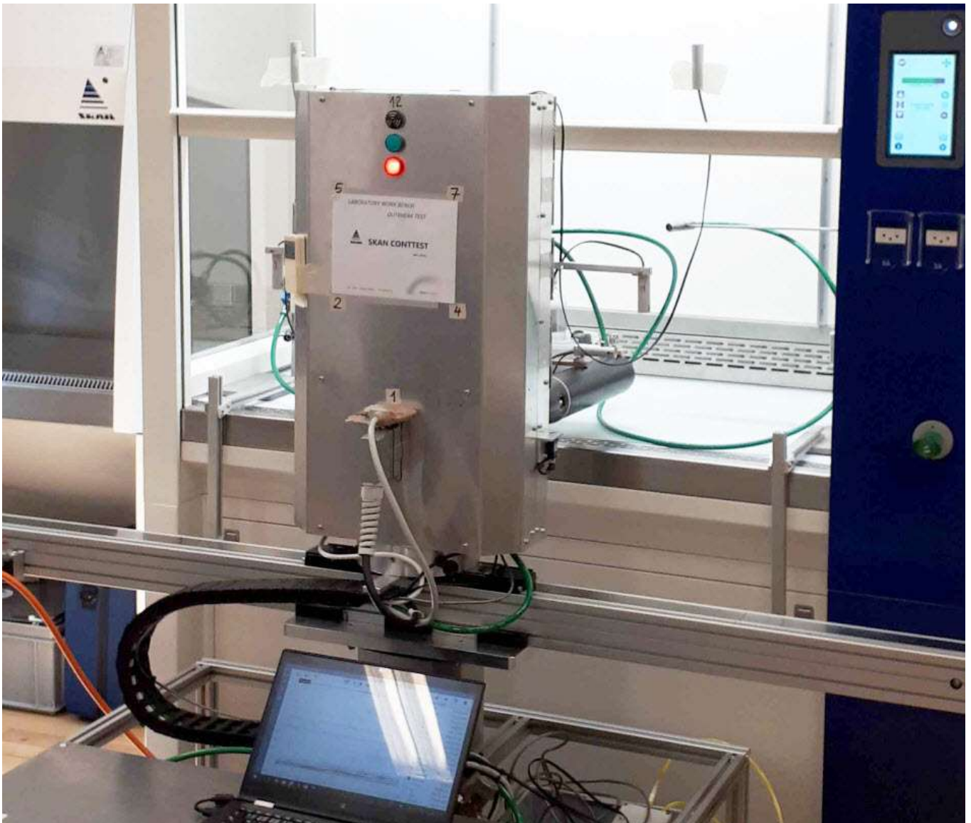
Aufbau des Conttest Ausbruchstest von SKAN Pure Solutions
