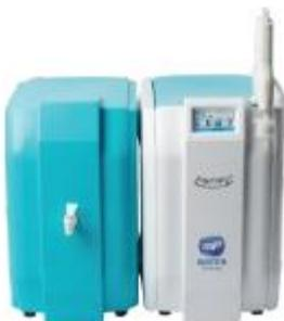
Eine Besonderheit ist die kombinierte UV-Lampe, die neben den üblichen 254nm auch mit 185nm arbeitet. Hier übernehmen die 254nm die Aufgabe der Desinfektion, die 185nm führen einen weiteren TOC-Abbau und die UV-Nassoxidation durch. Die eingesetzten Filterpatronen können vom Kunden selbst gewechselt werden und haben eine sehr hohe Standzeit.
