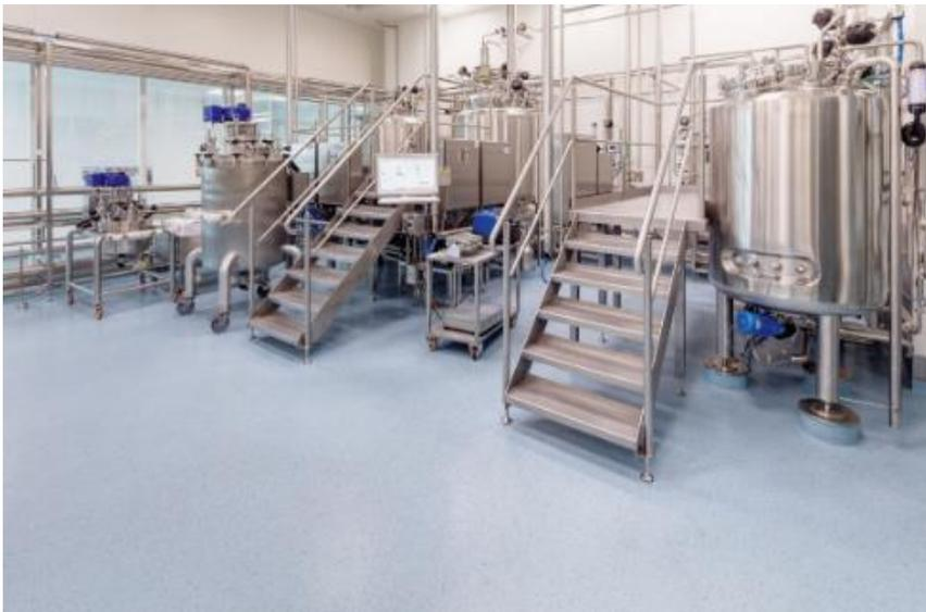
vorhandene Beläge oder bestehende Untergründe, wie Beschichtungen oder Pharmaterrazzo, installiert werden. Bei nora nTx sind die Beläge bereits ab Werk mit einer Kleberückseite ausgestattet. Nach dem Abziehen der Schutzfolie kann der Boden mit wenigen Handgriffen sauber und sicher verlegt werden und ist sofort begehbar. Die Reinräume können schneller wieder in Betrieb genommen werden, Trocknungszeiten entfallen.
