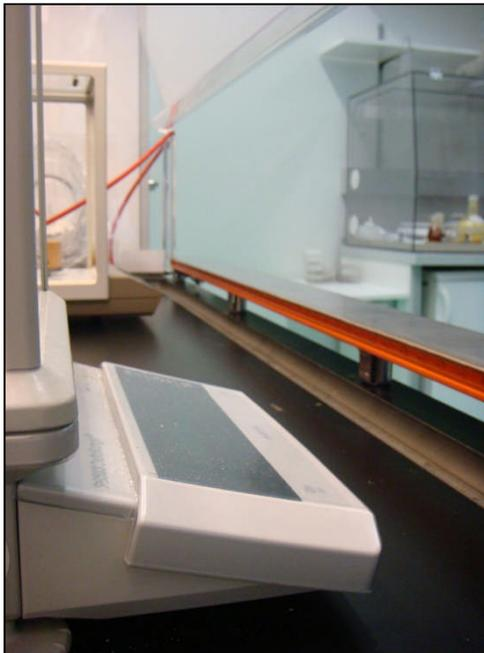
Beim Wägen und Hantieren mit Substanzen in Pulverform, kann es durch elektrostatische Ladungen zu fehlerhaften Messungen und/oder Problemen beim Umfüllen kommen.
