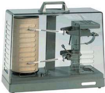
Thermohygrograph Messprinzip: Haar oder Kunstfaser
