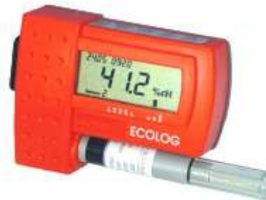
Kapazitive Messzelle Messprinzip: Präzisions-Thermometer
