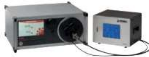
HygroGen2 mit externem Taupunktspiegel- hygrometer – Michell S8000 Remote
