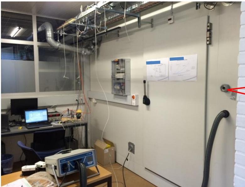
Ansicht der Prüfkabine von außen, hier: Lindab LT600 zur Messung des Leckluftvolumenstroms bzw. Bestimmung der Raumdichtheitsklasse nach VDI 2083-19 angeschlossen
